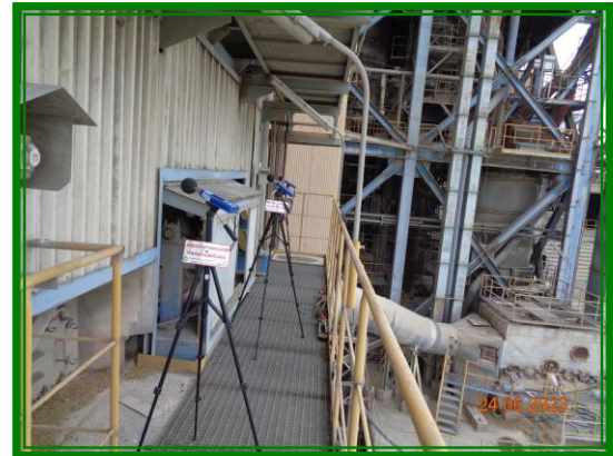
ภาพถ่ายการตรวจวัดระดับเสียงในสถานที่ทำงาน บริเวณ SP 5 Boiler ชั้น 7
