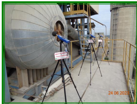
ภาพถ่ายการตรวจวัดระดับเสียงในสถานที่ทำงาน บริเวณ SP 5 Boiler ชั้น 12
