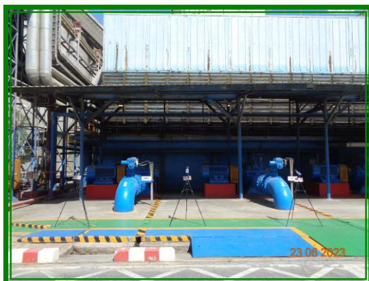
ภาพถ่ายการตรวจวัดระดับเสียงในสถานที่ทำงาน บริเวณ Cooling Tower
