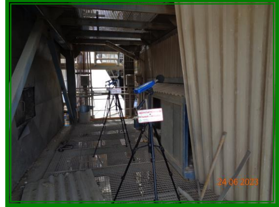
ภาพถ่ายการตรวจวัดระดับเสียงในสถานที่ทำงาน บริเวณ SP 5 Boiler ชั้น 5
